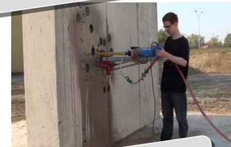
**Carottage de 30 cm de granit en 4 mn (perçage de Ø 30 mm)**
